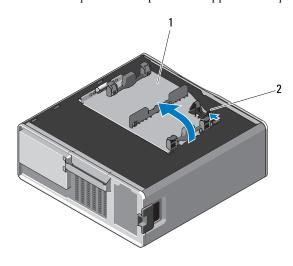
**b** Enlevez les vis fixant le support du disque dur au châssis; soulevez le support du disque dur et retirez-le de l'ordinateur.
